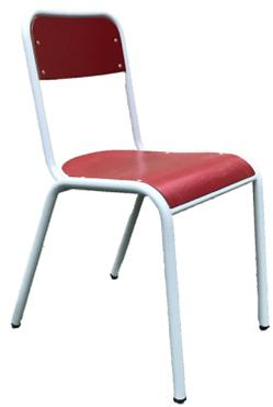
Silla escolar, compuesta por estructura metálica de tubo de Ø25x1,5 mm (patas) y de Ø22x1,5 mm (respaldo) y por dos piezas de madera contrachapada curvada de 10 mm de espesor, con superficie y contratiro de laminado de alta presión (HPL) con cantos redondeados. Incorpora conteras de goma en la base de las patas para reducir el deslizamiento, la vibración y el ruido. Apilables para aprovechar el espacio y reducir el impacto ambiental en su transporte. Acabado de la estructura en pintura Epoxi.
